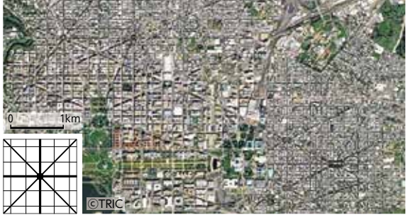
↑5 放射直交路型の都市(アメリカ合衆国、ワシントンD.C.) 地割りがしやすい上に、中心部へのアクセスもよい。
