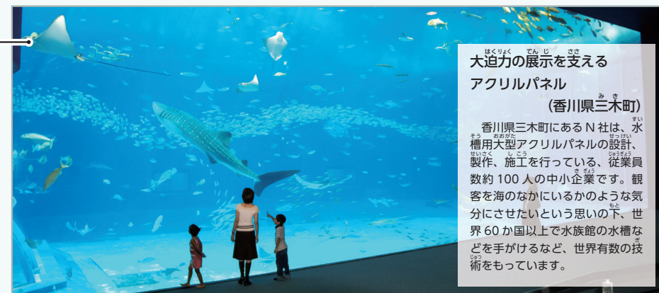
↑p.134-135 ↑1 沖縄美ら海水族館に設置された幅 22.5mのアクリルパネル(沖縄県本部町) この大型のアクリルパネルは、高い強度のアクリルを何層にも重ねることで、大きな水圧に耐えることができます。それにより、一本の柱も使わずに迫力ある展示が可能になっています。 ○対話 N社のように高い技術をもつことは、企業にとってどのような利点があるのだろうか。
